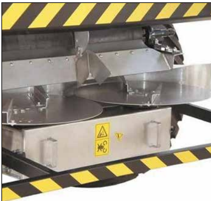
РОЗКИДАНІ ДИСКИ, ЗАХИСТ ДИСКІВ І КОРОБКА ШКІВІВ З НЕРЖАВІЮЧОЇ СТАЛІ
